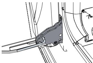
Взять дверцу за обе стороны двумя руками рядом с петлями, приподнять ее под углом приблизительно 30° и вынуть.
