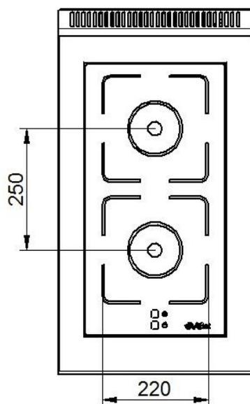
Плита индукционная кухонная настольная КИП-27Н предназначена для приготовления первых, вторых и третьих блюд в специальной наплитной посуде. Посуда должна быть с плоским дном, обладающая магнитными свойствами: посуда из нержавеющей стали или алюминия с ферромагнитным дном, чугунная посуда (посуда, к которой притягивается магнит).
