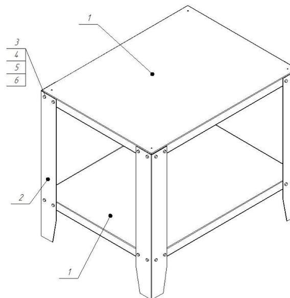
1– полка, 2 – ножка с регулируемой опорой, 3 – болт , 4 – гайка , 5 – шайба-гровер, 6 – шайба. Подставка поставляется в разобранном виде.
